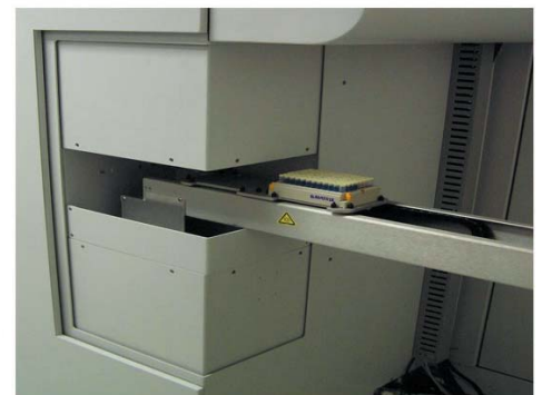
FIG 2. El sistema de Tekcel permite la carga manual o automática (integrada con otros equipos).
