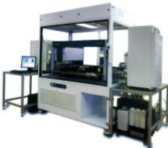
Figura 1: Sistema de cultivo celular completamente automatizado basado en la plataforma MICROLAB STAR. El sistema se encuentra dentro de una cabina de flujo laminar y se sirve de dos incubadores Kendro externos (4°C/37°C)
