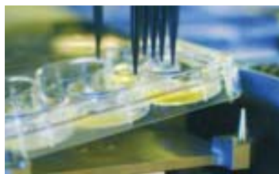
Figura 3: Inclinador de placas HAMILTON manipulando placas de cultivo para facilitar la eliminación completa del viejo medio.
