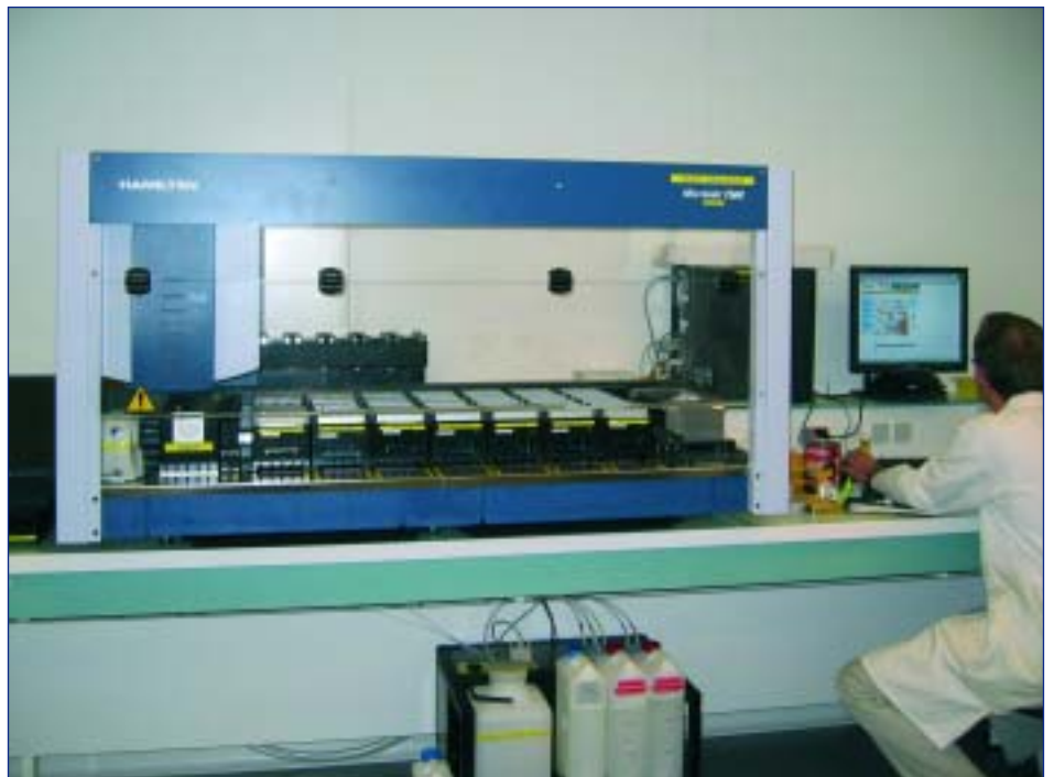
Figura 1.- Sistema automático de PCR set-up para el genotipado de plantas en el INRA en Rennes (Francia), basado en el MICROLAB STAR de HAMILTON.
