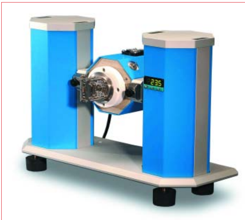
Analizador dinámico mecánico Tritec 2000 DMA de Triton Technology, con cabezal de medida orientable a cualquier ángulo.
