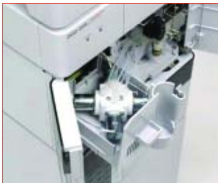
Figura 3.- Detalle del formador de gradientes cuaternarios, integrado en la bomba LC-20AT.
