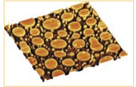
Fig. 2a: Imagen AFM de una mezcla de polímeros PMMA-SBR, spin coated sobre vidrio. Barrido 20x20μm, 30nm escala topográfica
