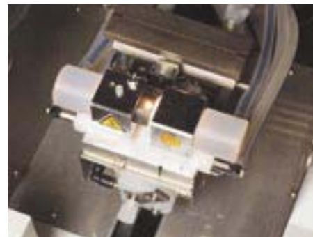
Figura 2. Detalle de la cámara de grafito GFA-EX7i.
