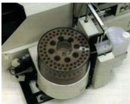
Figura 3. Detalle del automuestreador ASC-6100 y estación de auto-dilución e inyección en cámara de grafito ASK-6100.
