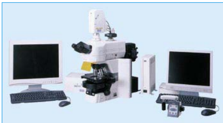
Cámara Nikon DS-5Mc-U1 junto con microscopio Nikon Eclipse 80i y accesorio confocal C1.
