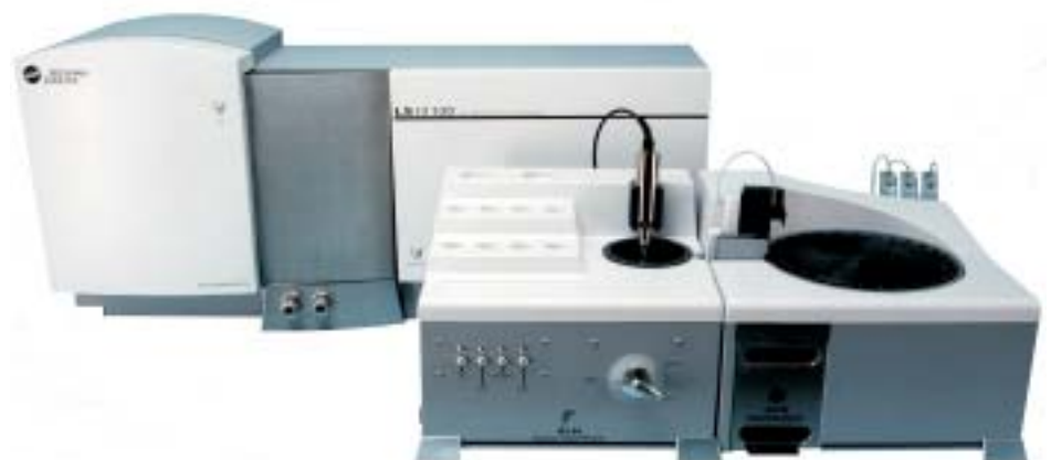
LS 13 320 de Beckman Coulter equipado con módulo de líquidos acuosos y estación de preparación de muestras automática / automuestreador.
