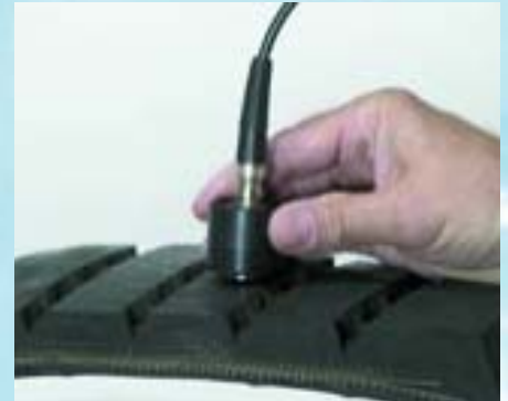
Medición de la profundidad de los cordones metálicos in cintas de transporte o cubiertas de ruedas.
