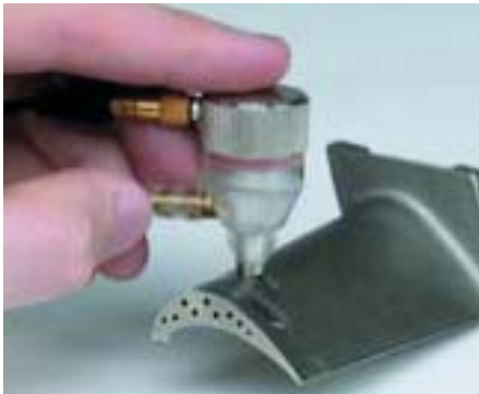
El modelo 35 con un palpador con delay o una cápsula de inmersión realiza medidas de gran precisión tanto en superficies cóncava como convexas de los alabes de turbina.
