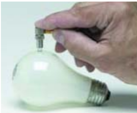
Los micrómetros no sirven para esta aplicación. En su lugar el 35 con el palpador M208 realiza estas mediciones con una precisión de 0,0001 mm.
