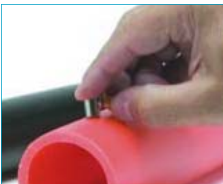
Los tubos o tuberías de plástico de diferentes diámetros pueden medirse fácilmente con palpadores de contacto. Para diámetros pequeños de tubo se necesita la técnica de inmersión.
