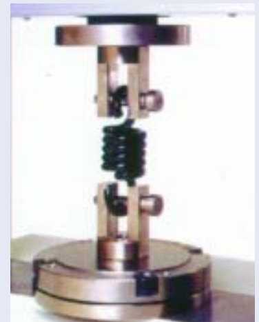
3.-Tracción en muelles en espiral Con esta nueva máquina es posible medir altura, deflexión (desplazamiento a compresión) del muelle y como no, la constante del muelle.
